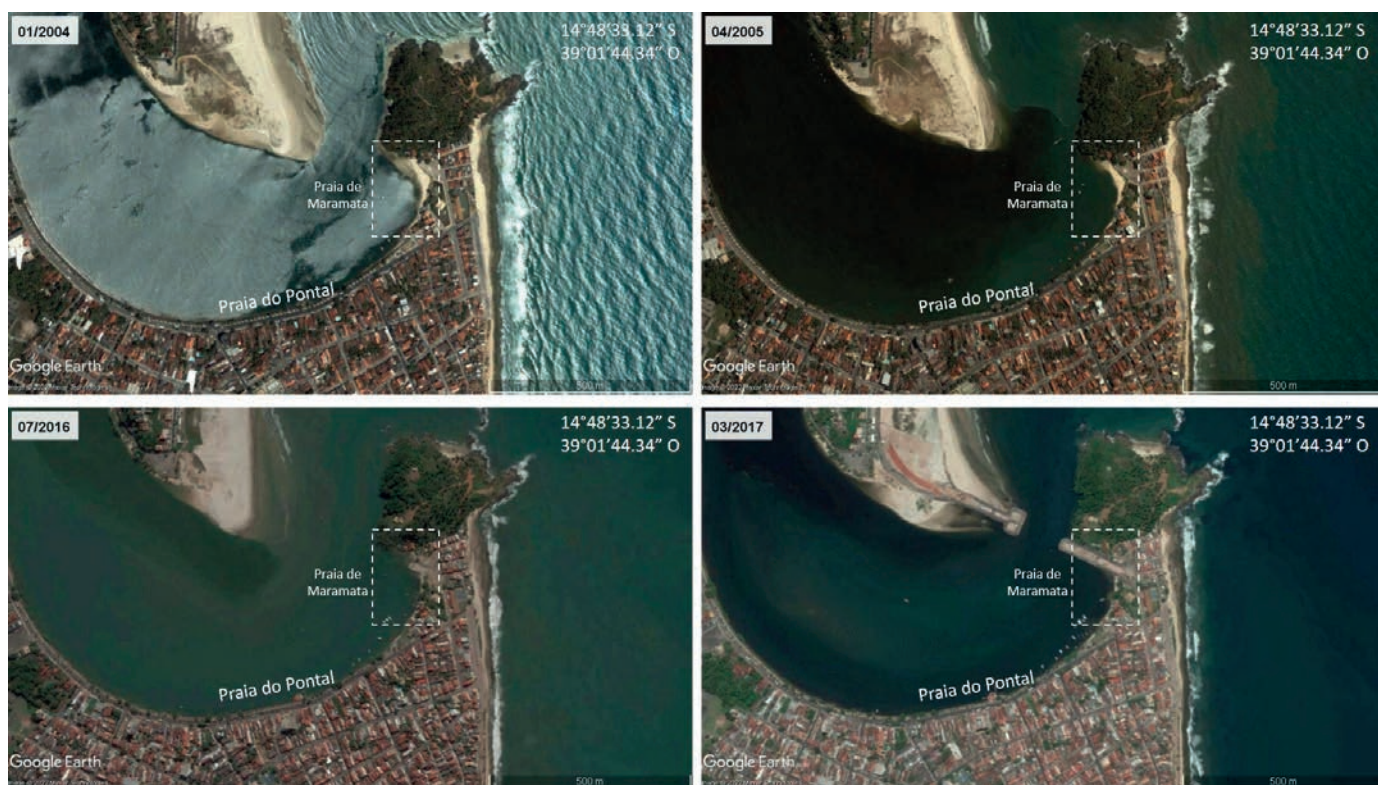
Figura 2 – Sequência cronológica de imagens da Baía de Pontal. Destaque para a erosão da Praia da Maramata. Fonte: Google Earth.
