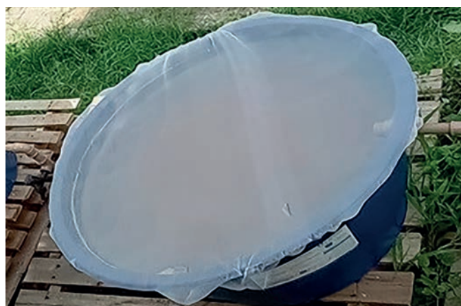
Figura 5 – Tela de proteção contra a entrada de agentes externos, no filtro físico do Tratamento 3 para biotratamento do efluente da Estação de Tratamento de Esgoto (E.T.E.) Orlando Dantas, Aracaju, SE, para reuso na produção de argamassa.
