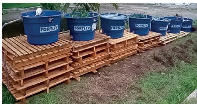
Figura 1 – Miniestação da etapa de tratamento com biorremediação (macrófitas e biofilme) montada.
