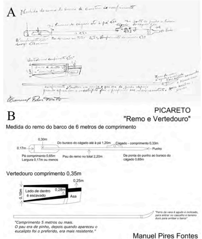
Figura 14. Remo, vertedouro e vara do barco para Profissionais. A: Desenho original do Calafate Manuel Fontes. B: Trabalho de revisão da Arq. a Elsa Severino.
