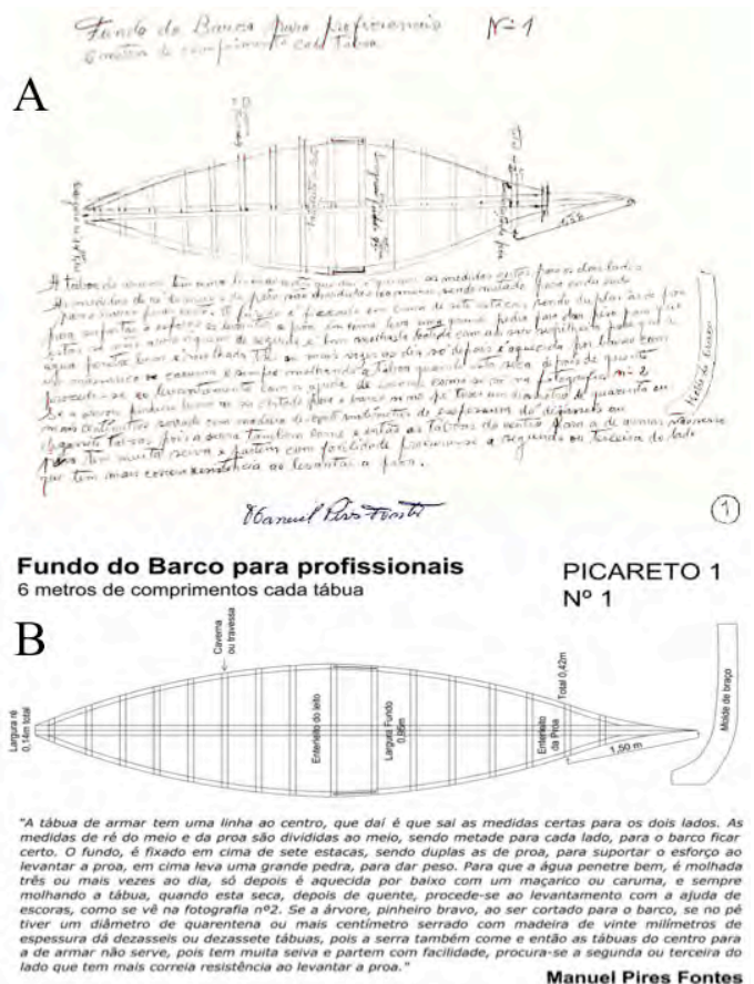
Figura 11. Fundo do barco para uso de profissionais. A: Desenho original do Calafate Manuel Fontes. B: Trabalho de revisão da Arq. a Elsa Severino.
