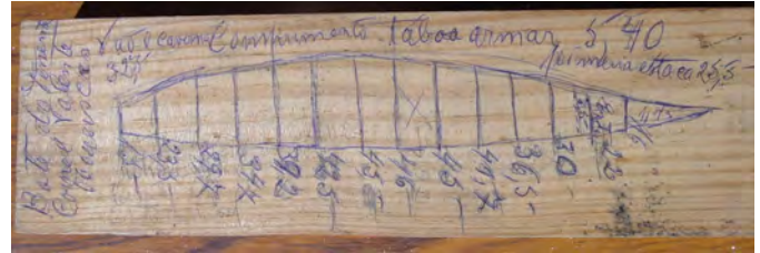
Figura 10. Fundo de barco, calculado pelo calafate Manuel Pires Fontes.
