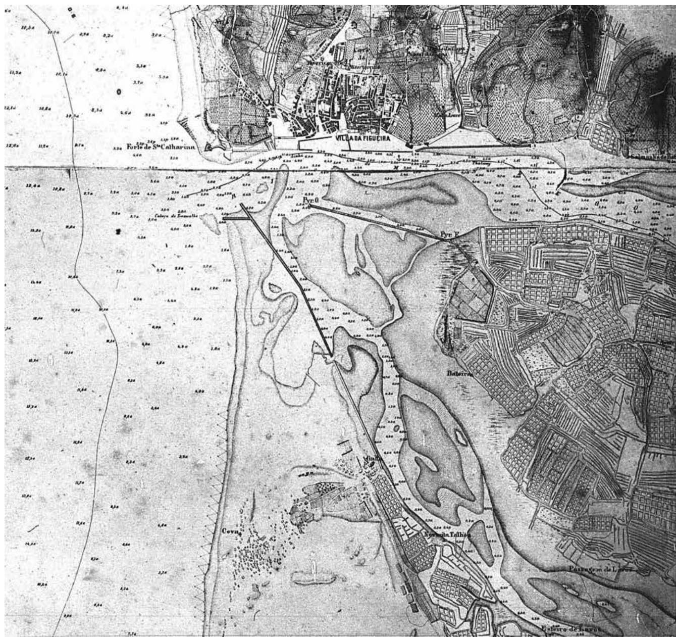
Figura 7. Plano Hidrográfico do Porto e Barra da Figueira, Filipe Folque, 1880. Atente-se no Esporão de Entre-Bocas, junto à ilha da Murraceira; no paredão de regularização da margem esquerda, no cabedelo; e à regularização da margem direita, junto da cidade (Biblioteca e Arquivo Histórico das Obras Públicas).
