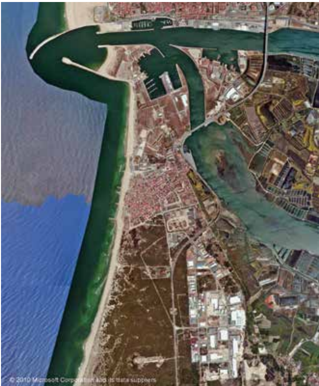
Figura 12. Sector litoral a sul da foz do rio Mondego, em 2010. Observe-se os esporões que protegem a povoação da Cova e diminuta largura da praia quando comparada com a extensão que se verifica imediatamente a norte do Molhe Norte (Microsoft Corporation, montagem de A. Mota Lopes).
