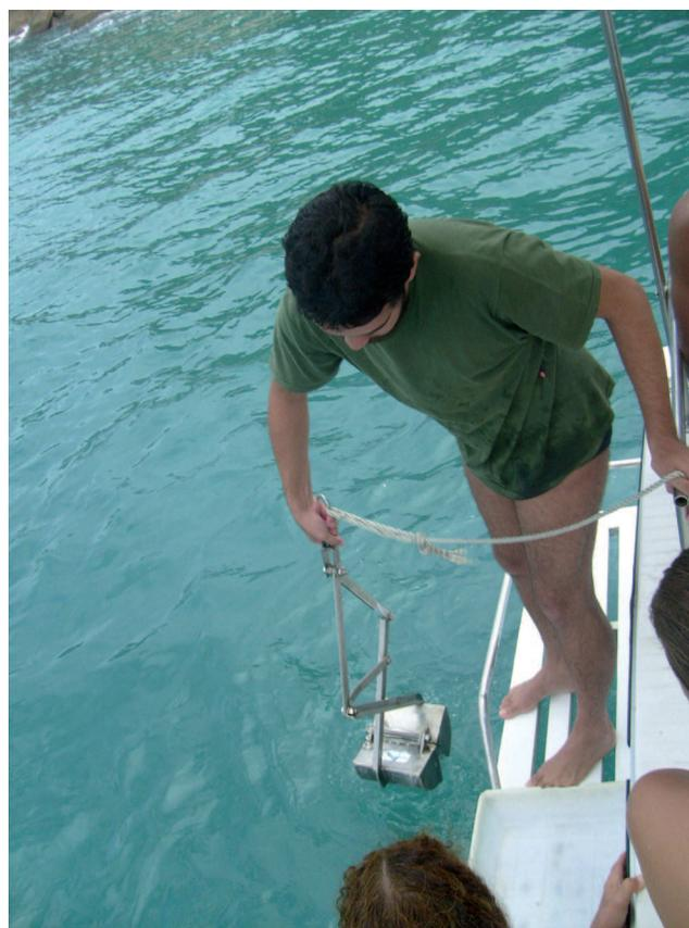
Figura 7: Coleta de sedimentos com amostrador Van-Veen
