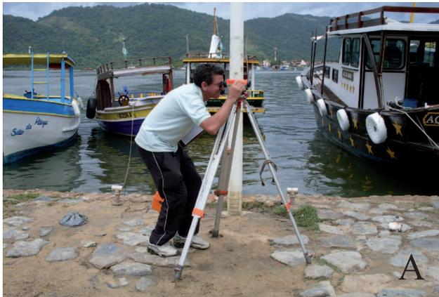
Figura 2: Nivelamento da Régua de maré no Cais de Paraty
