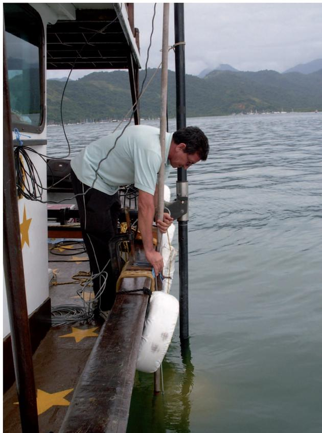
Figura 4: Calibragem do ecobatímetro
