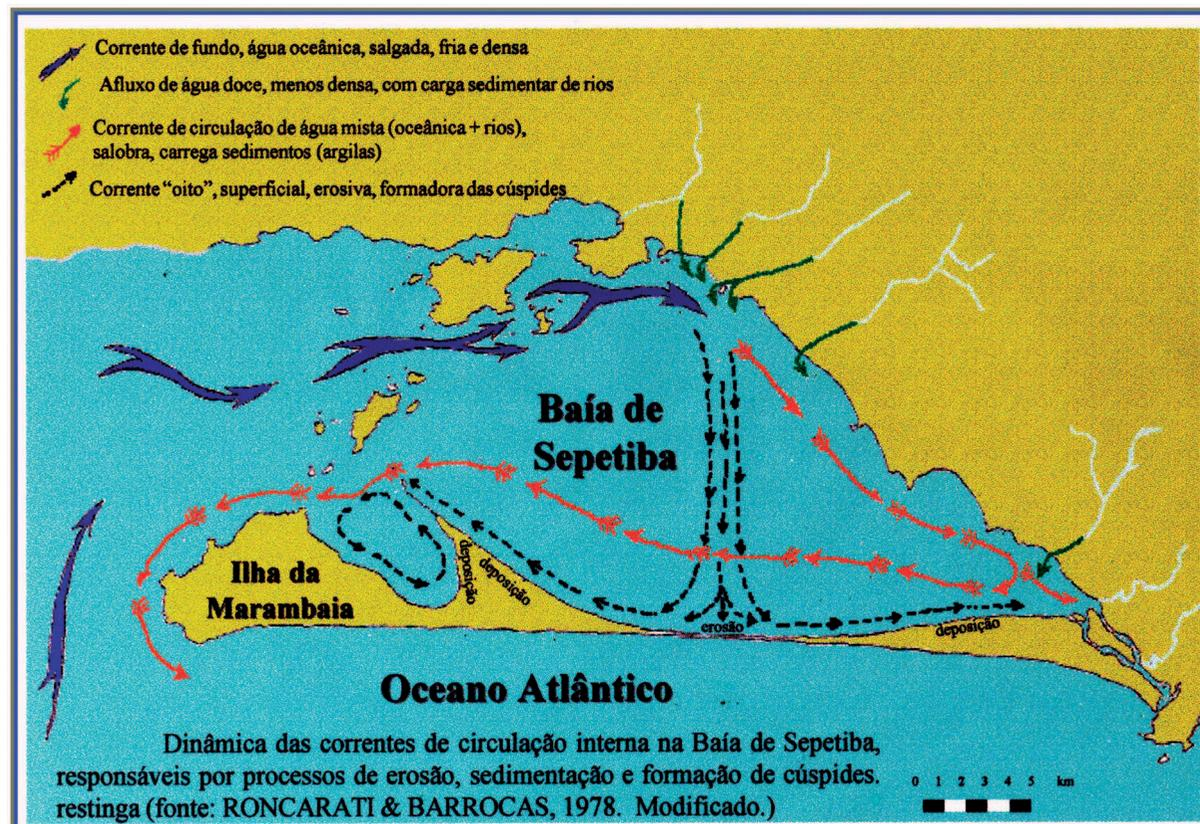
Figura 24: Dinâmica das correntes de circulação interna na baía de Sepetiba, modificado de Roncarati; Barrocas (1978).
